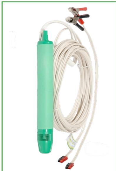
Pompa a 12V in plastica Mini-Typhoon con prevalenza di 12m dal piano campagna, collegandola ad una apposita batteria da 12V. Il suo design è perfetto per il campionamento in continuo, lo spurgo dei pozzi e il campionamento a basso flusso tramite l'apposito regolatore del flusso PA-10800 (fino a 40ml/min.). Con l'apposita valvola, in combinazione con il regolatore di flusso, si possono ottenere prelievi fino a 10ml/min.
